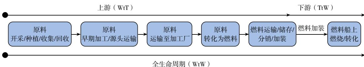
图1 船用燃料上、下游及全生命周期温室气体强度关系示意图
