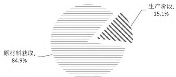
图4 汽车座椅生命周期各阶段酸化潜值
