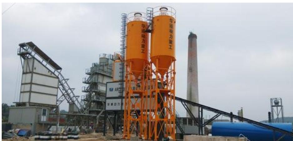
图 4-5 冷再生混合料拌合站
