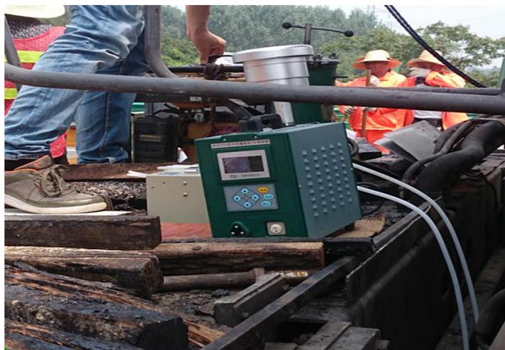
图 4-3 摊铺现场沥青混合料自身气体排放检测
