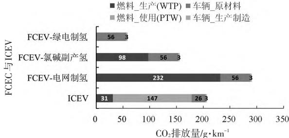
图6 不同制氢方式下燃料电池汽车生命周期碳排放量对比
