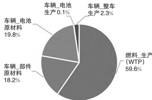
图5 纯电动汽车产品生命周期CO<sub>2</sub>排放量构成
