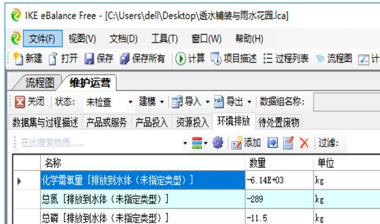
图 3-5 透水铺装+雨水花园运行维护阶段对污染物去除清单数据
