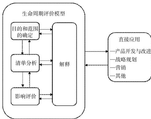
图1 LCA的阶段
