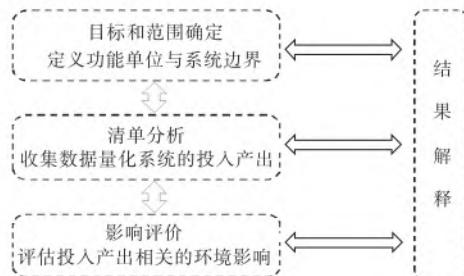
图1 LCA方法框架示意
