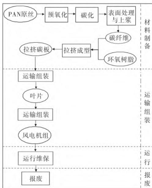
图2 CFRP风电叶片的生命周期过程
