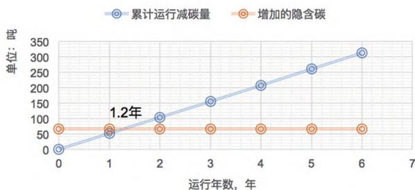
图 10 超低能耗建筑增加的隐含碳回收中和分析图
