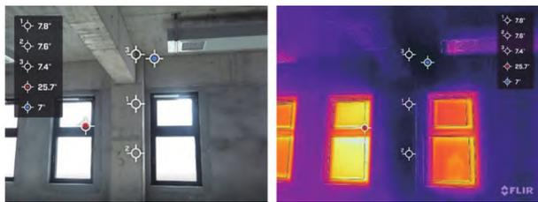
图 2 南向外墙热桥部位红外检测效果
