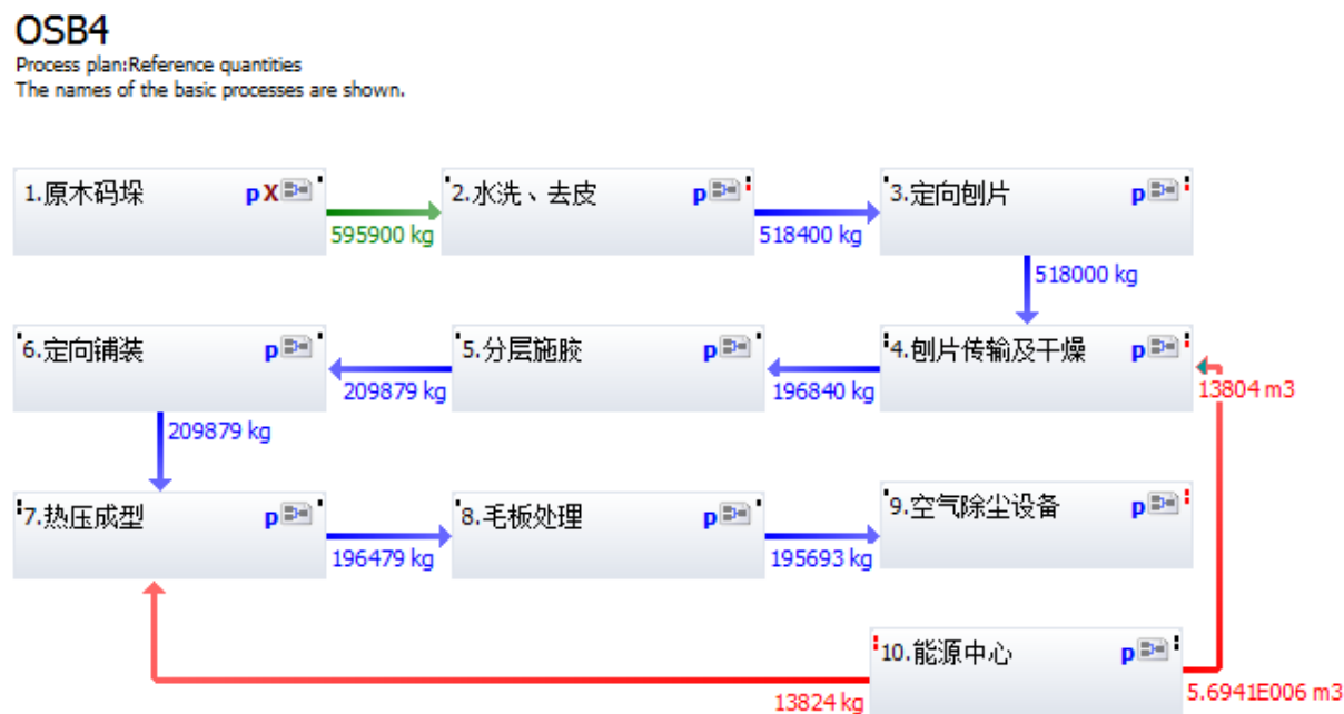
图 3-5 268.9m 3 OSB 4 的 LCA 生命周期物质流模型
