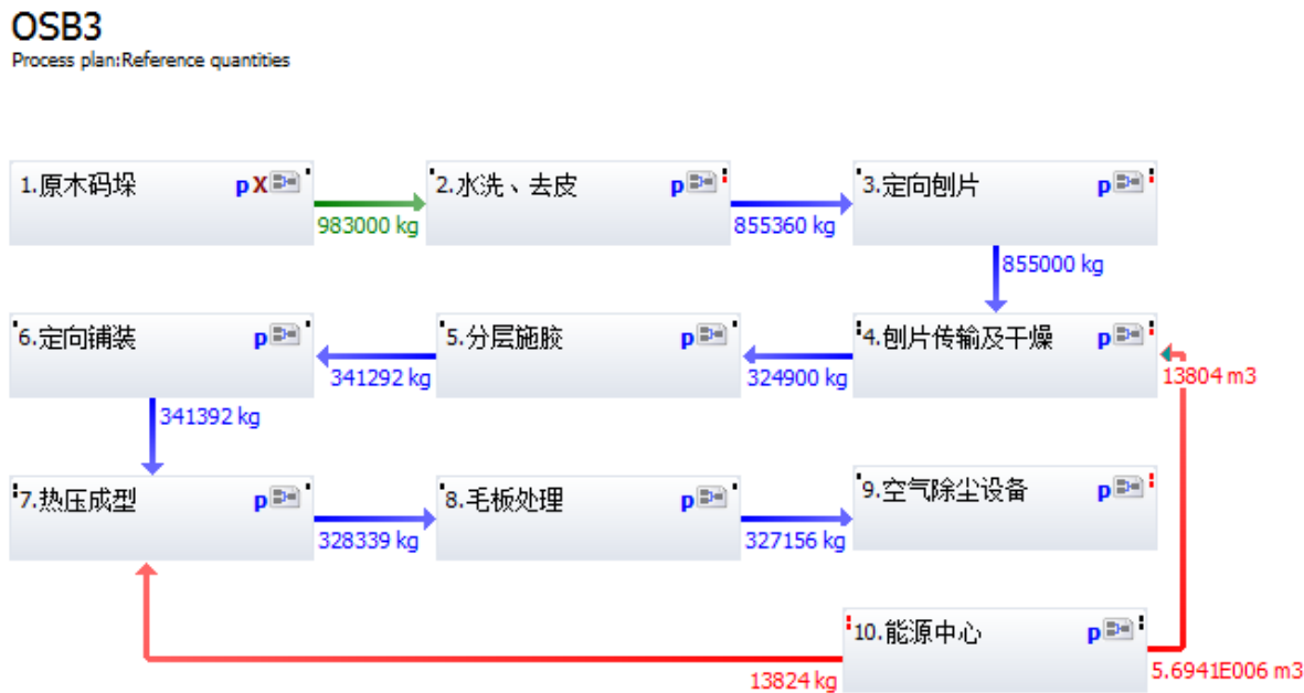
图 3-4 493m 3 OSB 3 的 LCA 生命周期物质流模型
