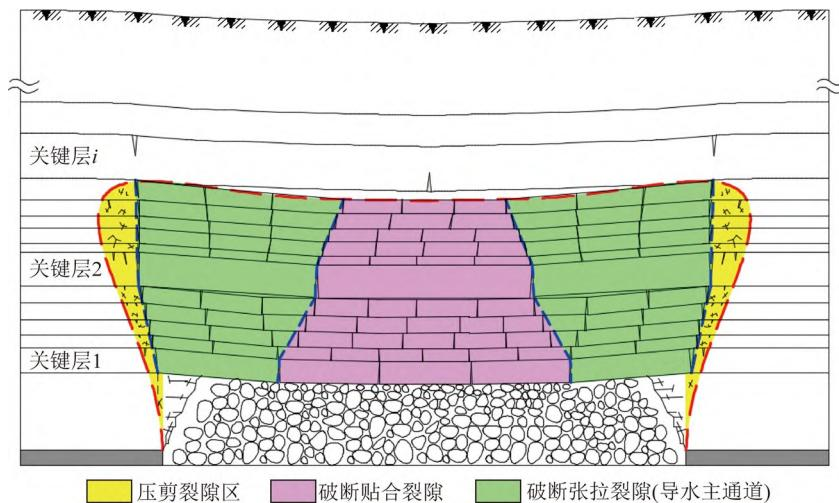
图7 采动覆岩导水裂隙分区及其主通道分布剖面模型(充分采动状态)
