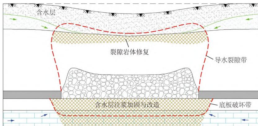
图6 顶、底板采动含水层导水通道注浆封堵的修复示意
