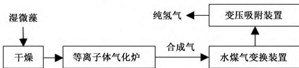
b—等离子体气化系统的工艺流程
