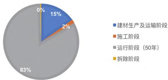
图9 超低能耗建筑全生命周期 LCA 碳排放占比图
