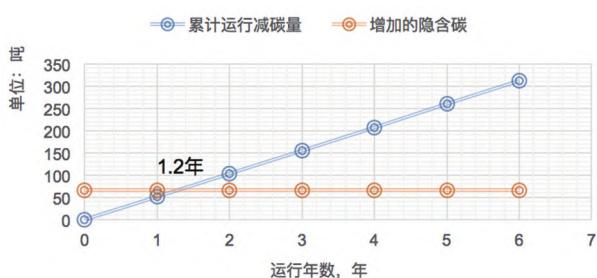
图10 超低能耗建筑增加的隐含碳回收中和分析图
