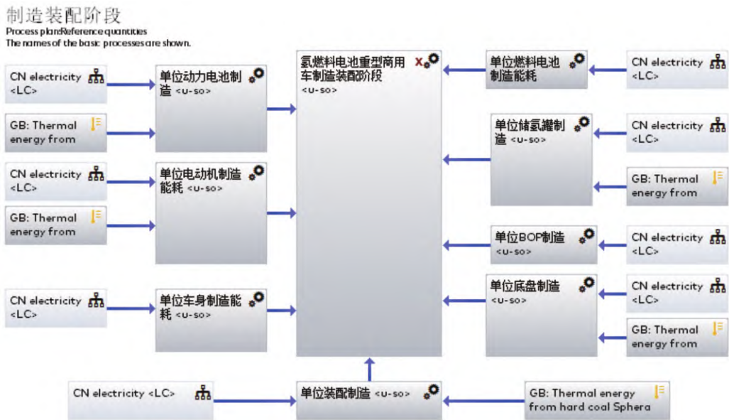
图3 FCHCV制造装配阶段的GaBi模型
