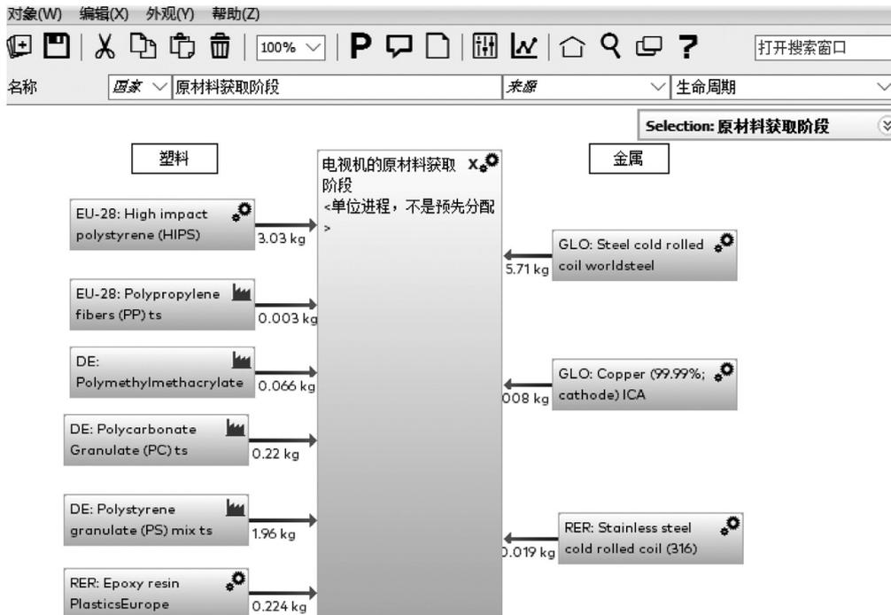
图2 电视机原材料阶段模型
