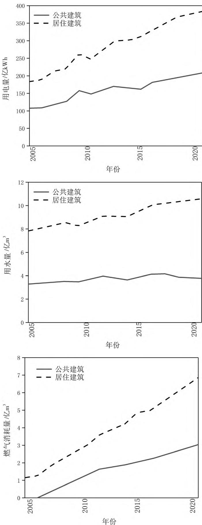
图 3 2005 年~2020 年公、民用建筑的能源消耗量变化图
