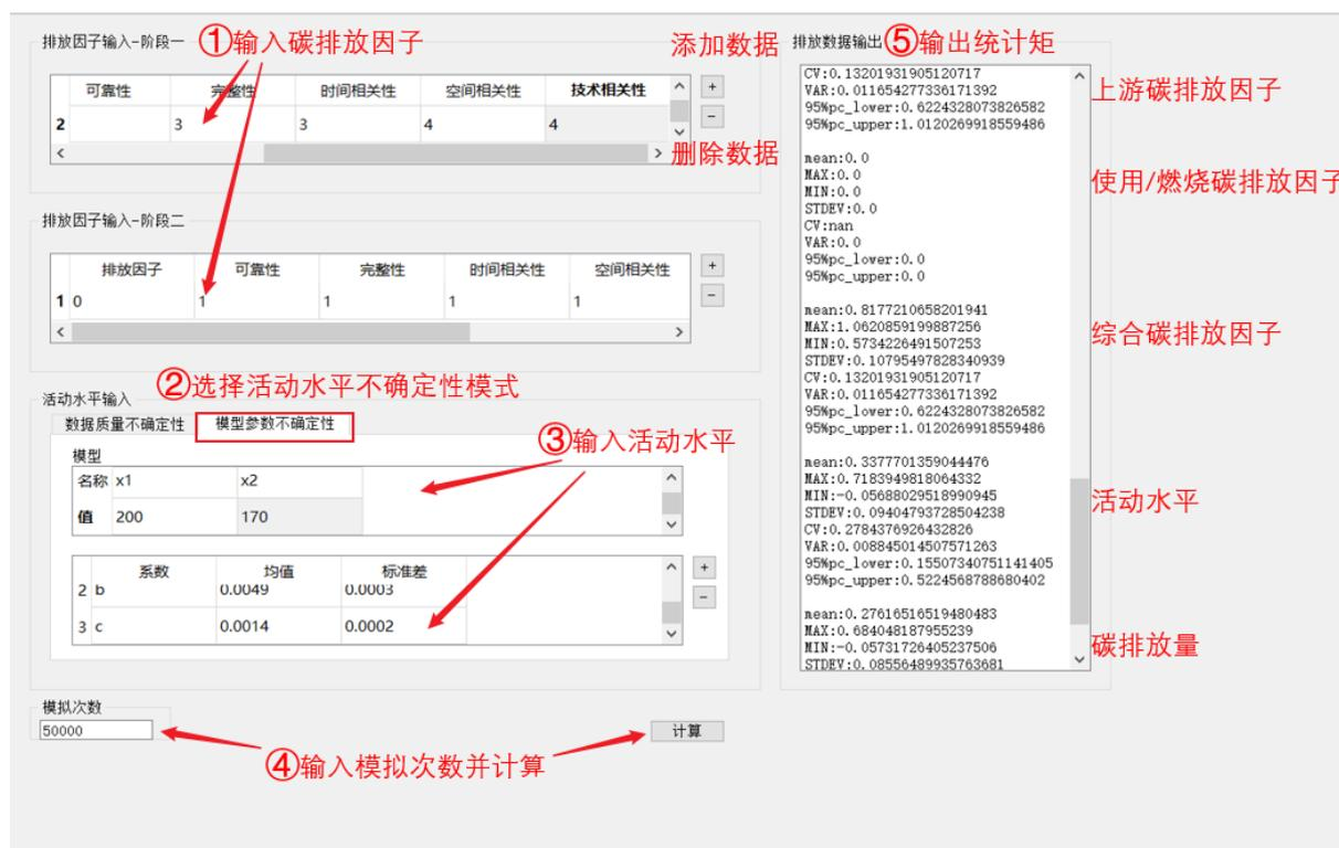
图 5.10.2 软件分析碳排放数据质量-模型系数不确定性示意图
