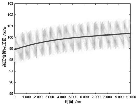
图5 高压油管内压强随单向阀开启时长的关系
