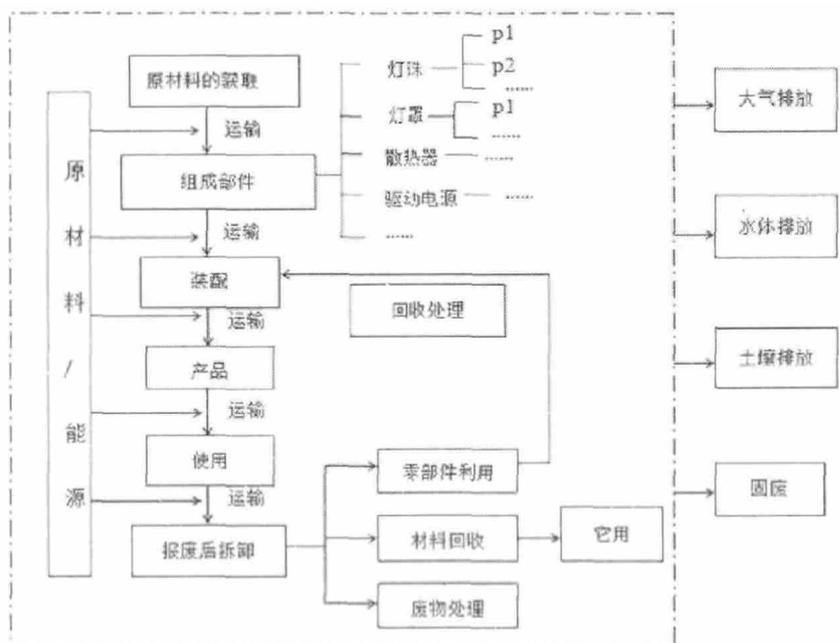
图3 LED照明产品生命周期流程示意图
