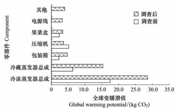
图4 供应商调查前后主要零部件全球变暖潜值对比
