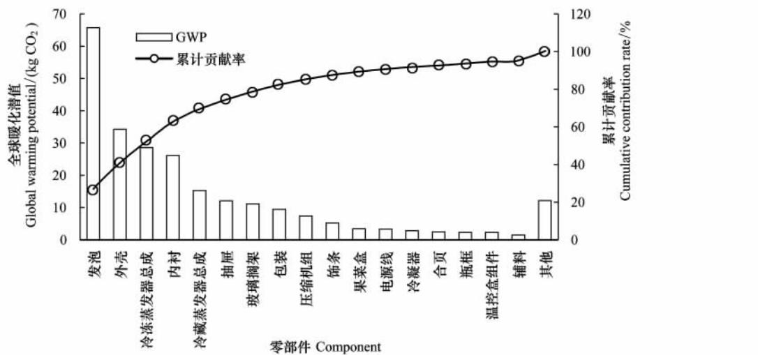
图3 冰箱主要零部件全球暖化潜值
