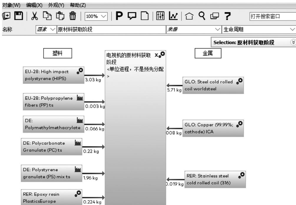
图 2 电视机原材料阶段模型
