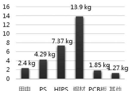
图 8 电视机生产制造阶段碳排放
