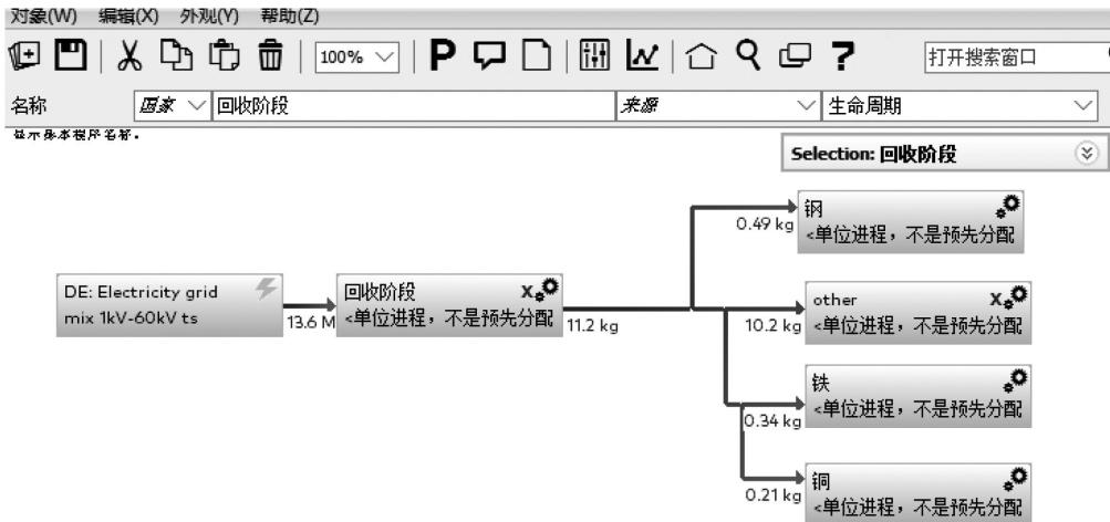
图 6 电视机回收阶段模型
