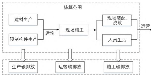
图2 预制装配式变电站核算碳排放分析系统边界
