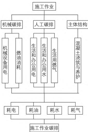
图3 装配式建筑施工作业碳排放
