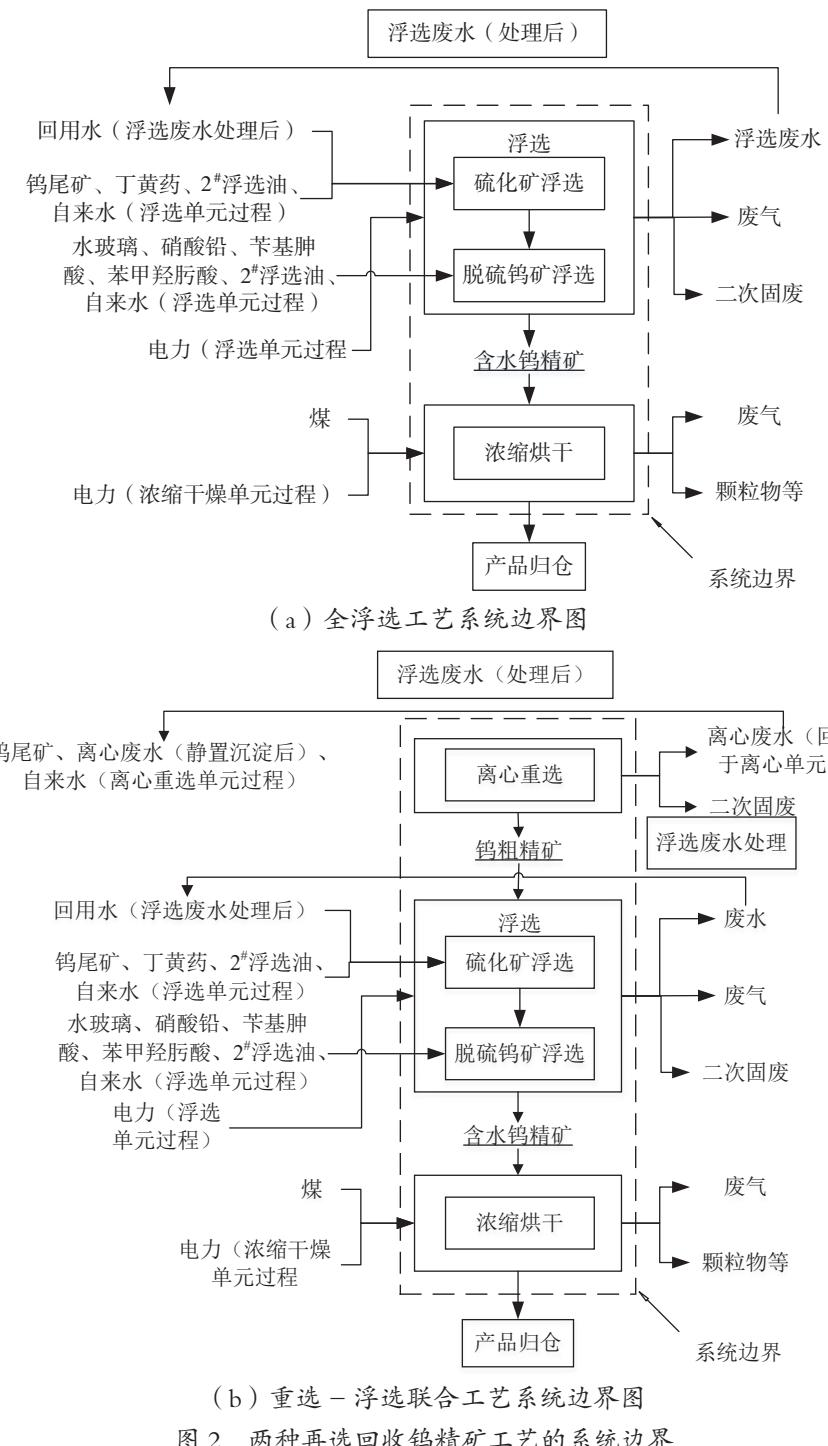
图 2 两种再选回收钨精矿工艺的系统边界
