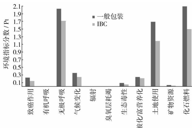
图3 瓦楞纸箱和纤维板 IBC 全生命周期量化比较结果
