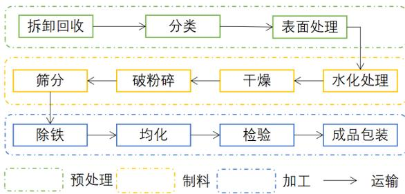
图1 用后耐火材料回收处理工艺
