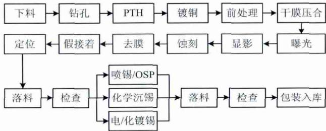
图4 双面板生产工艺流程图
