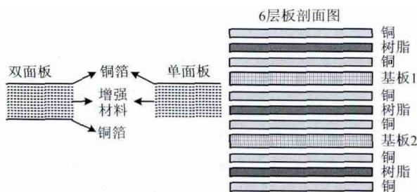
图2 线路板结构图
