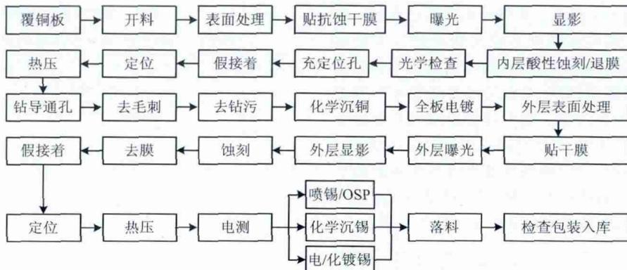
图 5 多层板生产工艺流程图
