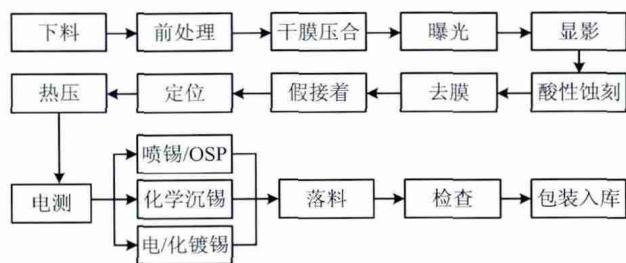
图3 单面板生产工艺流程图
