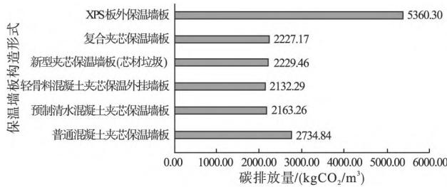
图 6 运营阶段各保温墙板 CO<sub>2</sub> 排放量
