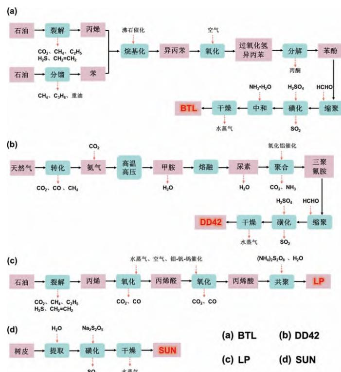
图 4 不同复鞣剂的生产流程<sup>[34-37]</sup>
