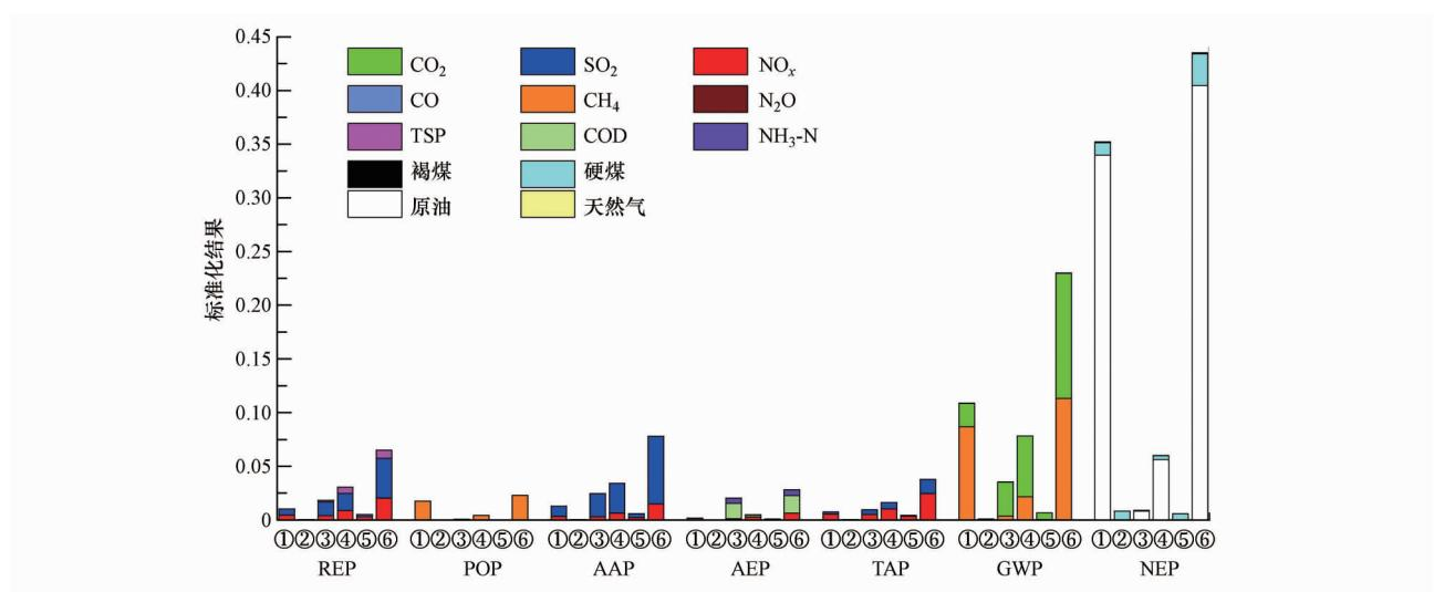
图3 1 t 乙烯生产的中间类型环境影响( ①原油生产过程 ②原煤生产过程 ③原料生产过程 ④乙烯生产过程 ⑤电力生产过程 ⑥生命周期总排放)
