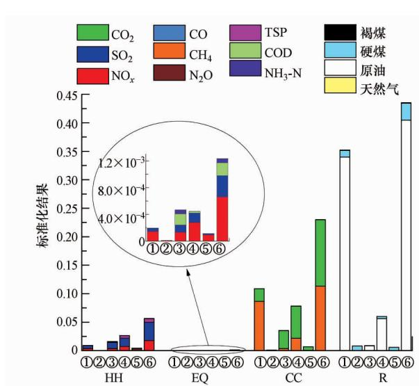
图4 1 t 乙烯生产的结果类型环境影响(①原油生产过程,②原煤生产过程,③原料生产过程,④乙烯生产过程,⑤电力生产过程,⑥生命周期总排放)
