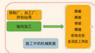
图3 建设阶段机械耗能量化边界条件的界定
